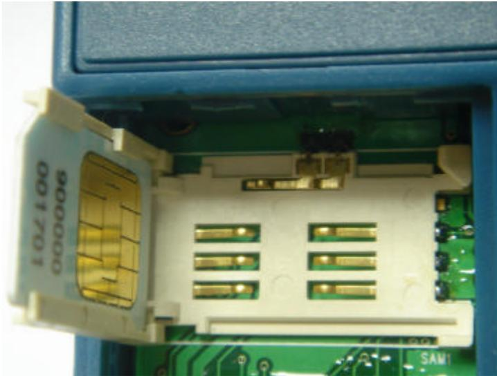
步驟 4：將「上蓋」下壓至底座，並往 LOCK 方向移動，固定卡片。並將背蓋關起，鎖緊螺絲。
